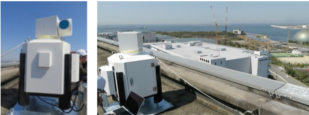
アジア太平洋トレードセンタービル屋上に設置した小型ドップラー・ライダー（ミラーが水平 360 度、垂直 90 度回転し、万博会場予定地と大阪ベイエリア一帯の風の状況を 3 次元で計測することができる）
